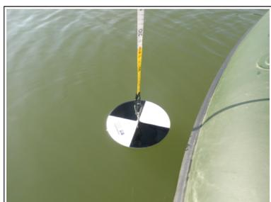
Figure 1 : Disque de Secchi
