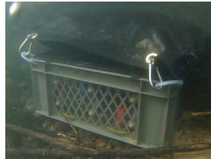
Figure 14 : Système d'immersion contenant les cages de gammares
