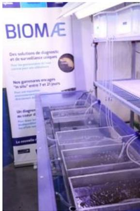
Figure 5 : Dispositif de maintien d'organismes « contrôles »
