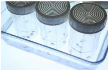
Figure 10 : Cylindres en polypropylène utilisées pour l'encagement de gammares
