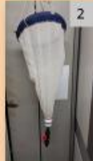
Le filet (maille 50 µm) dispose à sa base d'un collecteur pour recueillir le zooplancton.
