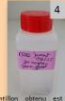
Echantillon obtenu est recueilli dans un flacon auquel est ajouté de l'eau gazéifiée pour endormir les organismes et ensuite du formol 4% pour la conservation.
