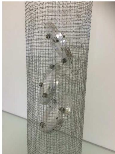
Figure A2. Système de cage pour exposition des capteurs dans la rivière
