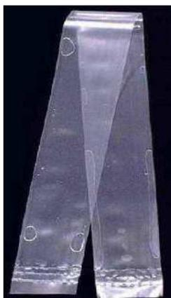
*Figure 3 : SPMD formé d'une membrane de perméation en LDPE remplie de trioléine (Huckins et al., 2006)*
