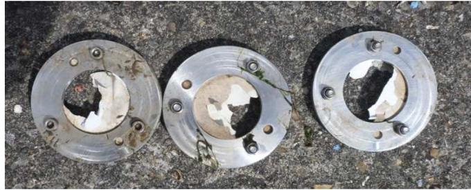
Figure 13 : Capteurs à l'ouverture des boitiers (Août 2014).
