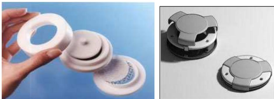
*Figure 5 : Modèles de Chemcatchers : (gauche) ancienne génération, (droite) nouvelle génération (Université de Portsmouth)*
