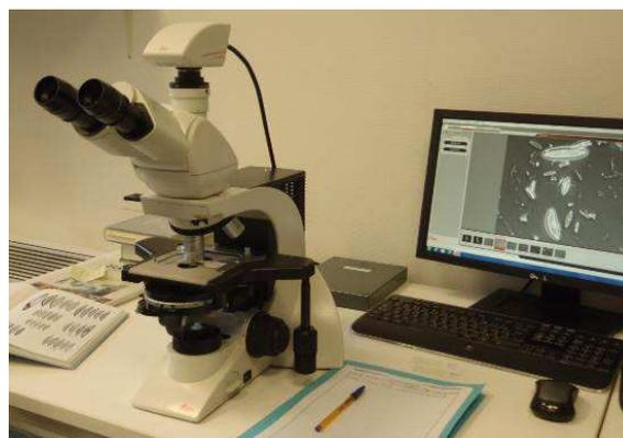
Microscope Leica à contraste de phase et interférentiel équipé d'une caméra numérique (Aquascop)
