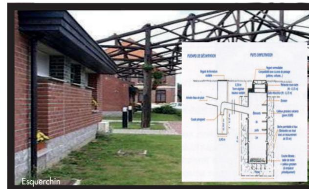
Ouvrage de profondeur plus ou moins importante évacuant les eaux pluviales directement dans le sol ou le sous-sol. N'avoir recours au puits que pour les petites parcelles et/ou les eaux de toiture.
