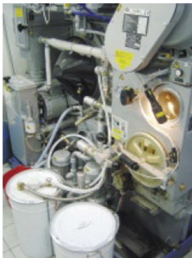
Source : Agence de l'Eau, machine de nettoyage et bac de récupération des boues solvantées
